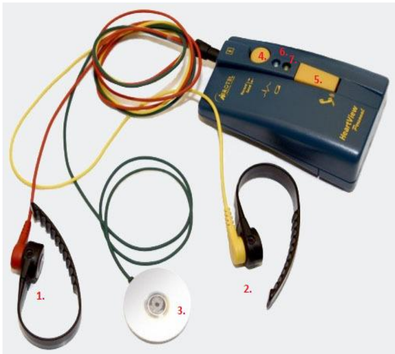
2. kép (HeartView P12/8 Plus készülék: felvevő egység, speciális kábelek. Forrás: IMS Kft.)
